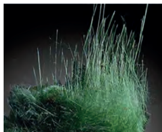
Актинолит-биссолит (\text{Ca}_2(\text{Mg}, \text{Fe})_3[\text{Si}_6\text{O}_{22}](\text{OH}))
